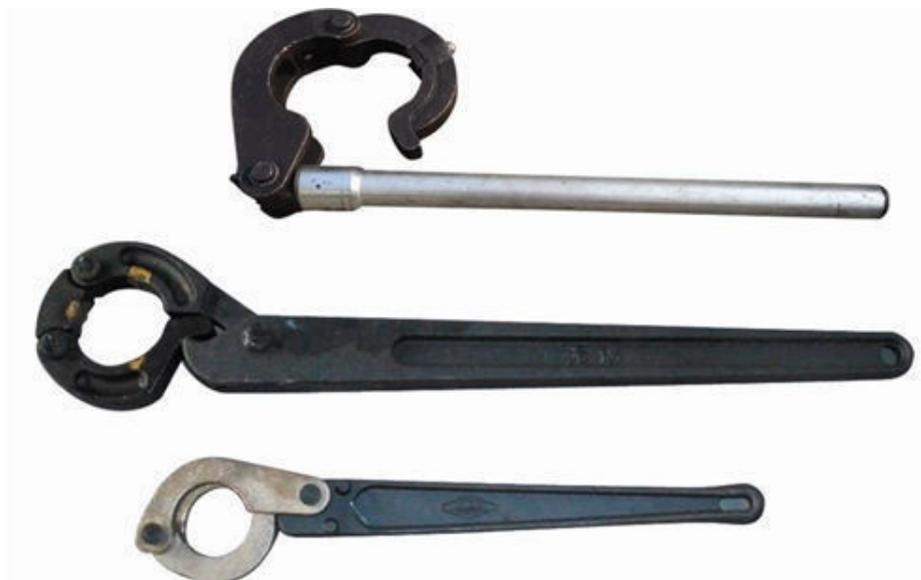
Рисунок 1.5 - Ключи для свинчивания колонковых труб
